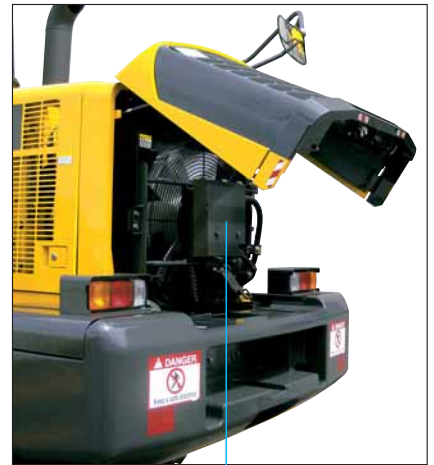
Hydraulic driven fan
