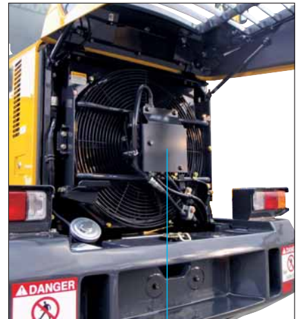
Hydraulic driven fan
