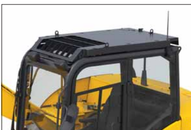
Bolt-on top guard, OPG level 2 (ISO 10262)
